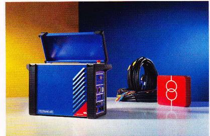
Es kann mit der Testrano TouchControl auf dem integrierten Touchdisplay oder über die etablierte Primary Testing Manager™-Software auf dem Laptop bedient werden.
